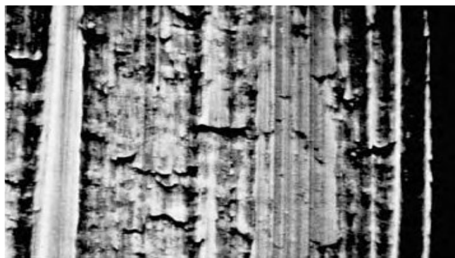
سطح ناهموار یک نمونه فولادی ۴۱۴۰ پس از مته کاری خشک
